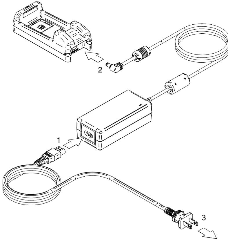
**Figura 17-2 Collegamento di caricabatterie e adattatore CA**
