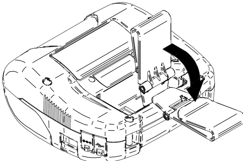
**Figura 14-2 Installazione della clip da cintura (2)**
