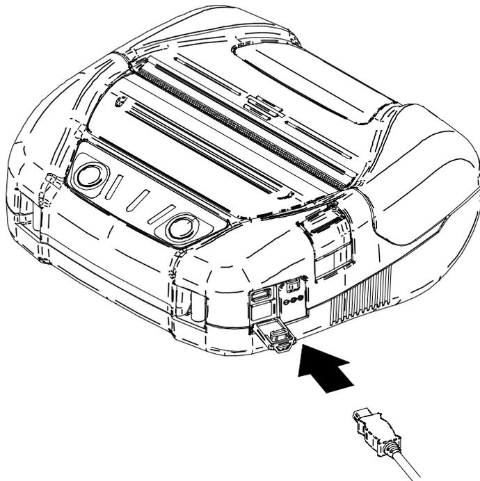
**Figura 12-1 Cavo di interfaccia per comunicazione USB**
