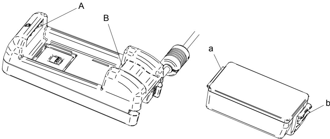
**Figura 17-4 Direzione della batteria**
