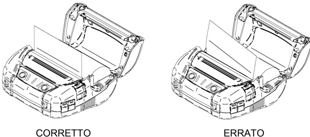
**Figura 9-3 Esempio di direzione di sistemazione della carta termica**
