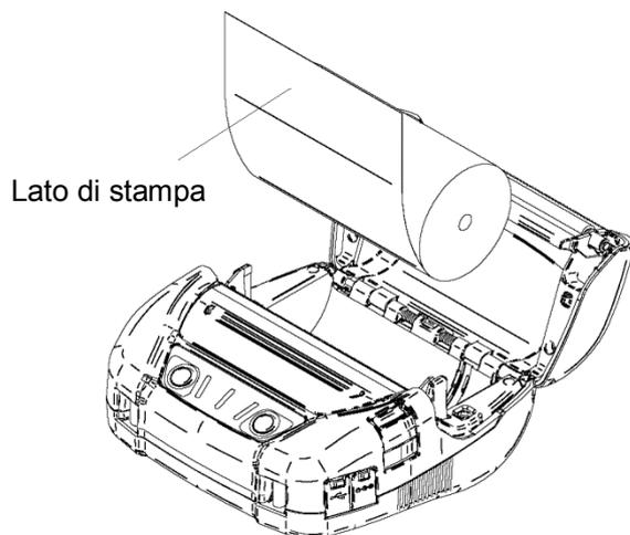
**Figura 9-2 Direzione di sistemazione della carta termica**
