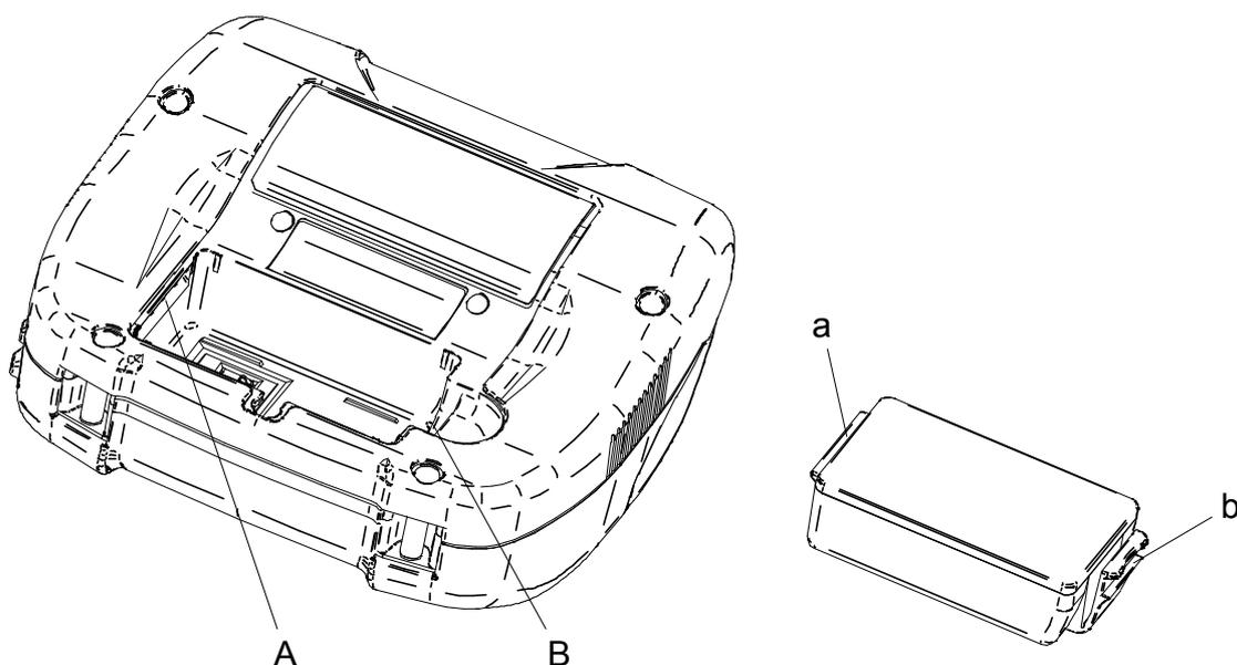
Figura 8-1 Installazione della batteria (1)
