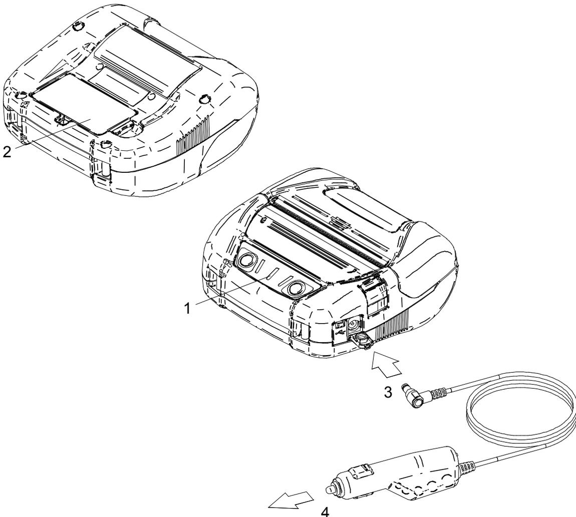
**Figura 16-2 Ricarica normale tramite il caricatore per auto**
